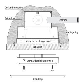
Die Zuführung der Installationskabel erfolgt über die Betondose. Den Montagering mit Nägeln unverrückbar und dicht auf der Schalung befestigen. Nach dem Betonieren und dem Installationseinzug den Universalsockel mit beiliegenden Schrauben im Montagering montieren. Den Blendring später zusammen mit dem Melder einsetzen.
