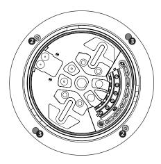
Den Montagering von unten in den vorbereiteten Deckenausschnitt stecken und mit den integrierten Spreizkrallen ② oder mit zwei Schrauben ③ (Befestigungslöcher) an der Decke befestigen. Den Blendring später zusammen mit dem Melder einsetzen (überdeckt die Schrauben).
