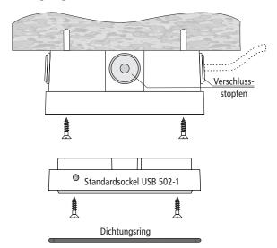
Die Montagedose mit zwei Schrauben an der Decke befestigen. Verschlussstopfen durchstechen, Kabel durchführen und den Universalsockel mit der Dose verschrauben. Den Dichtungsring später zusammen mit dem Melder einsetzen. Bei Bedarf können die Verschlussstopfen gegen Kabelverschraubungen PG 13,5 ausgetauscht werden.
