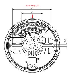
Die Sockel nicht direkt oberhalb von Kabelkanälen, Wasserleitungen und ähnlichem platzieren. Zu Lampen, Wänden, Deckenunterzügen etc. einen seitlichen Abstand von mindestens 0,5 m einhalten.
