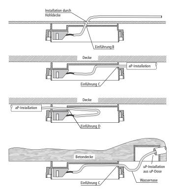
Den Sockel dauerhaft gegen Druck-, Zug- und Drehbewegung mit zwei Schrauben sichern. Dazu die zwei elastischen Einlagen A (Langlöcher) im Sockelboden durchstechen. Installationskabel einführen und den Sockel auf einer glatten, sauberen Fläche montieren.
