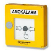
Handfeuermelder mit Isolator für den Notifier -Ringbus In Aluminium-Druckguss mit integriertem Überwachungsmodul, roter LED und beidseitiger Isolator zur automatischen Isolierung von Ringabschnitten bei Kurzschluss der Ringleitung.
