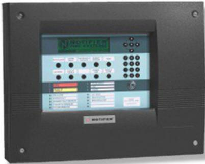
Die Brandmelderzentrale NF 5000 besteht aus mehreren Modulen. Für den Grundausbau ist ein BEK-5000 Modul notwendig. Dieses Modul beinhaltet die Prozessorkarte mit Systemsoftware, die P2P-CU Netzwerkkarte, die Anzeige und Bedienungstasten der BMZ sowie zwei Ringleitungen.
